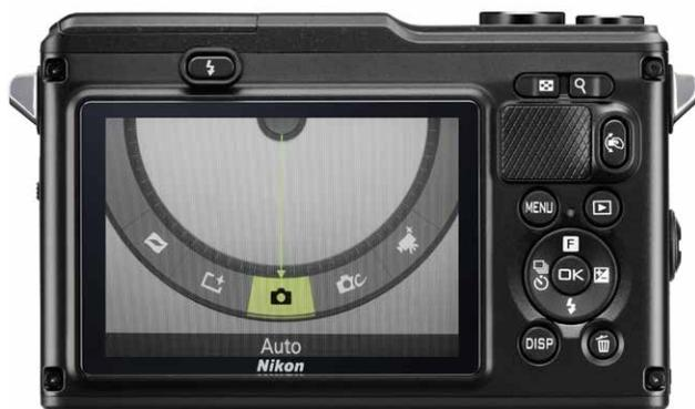
Grazie al sistema "Action Control" con la pressione di un solo pulsante possiamo cambiare la modalità di registrazione. Facile: basta inclinare lateralmente la fotocamera.
